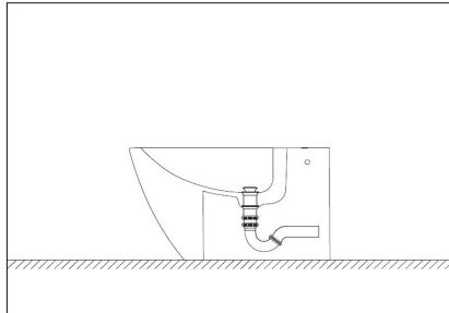
6. Если канализационное отверстие расположено в стене то установите трубу, как указано на рисунке.
