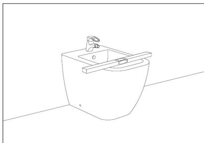
8. Включите воду и выполнить проверку соединений на предмет протекания. Выровняйте биде с помощью уровня.
