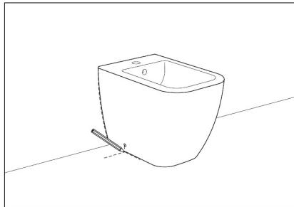
1. Определите место установки биде, отрегулируйте положение с помощью уровня и нанесите разметку на пол и стену
