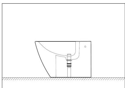
5. Если канализационное отверстие расположено в полу то установите трубу, как указано на рисунке.
